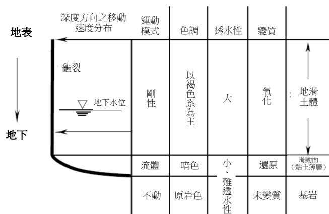
圖2-7 地滑坡面之構成 8) 部分修正而成
