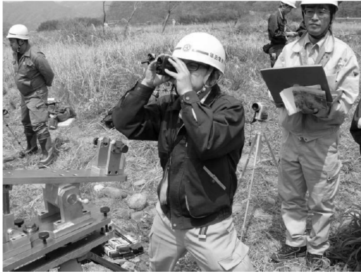
照片參-7 以雷射測距儀量測斜距離
