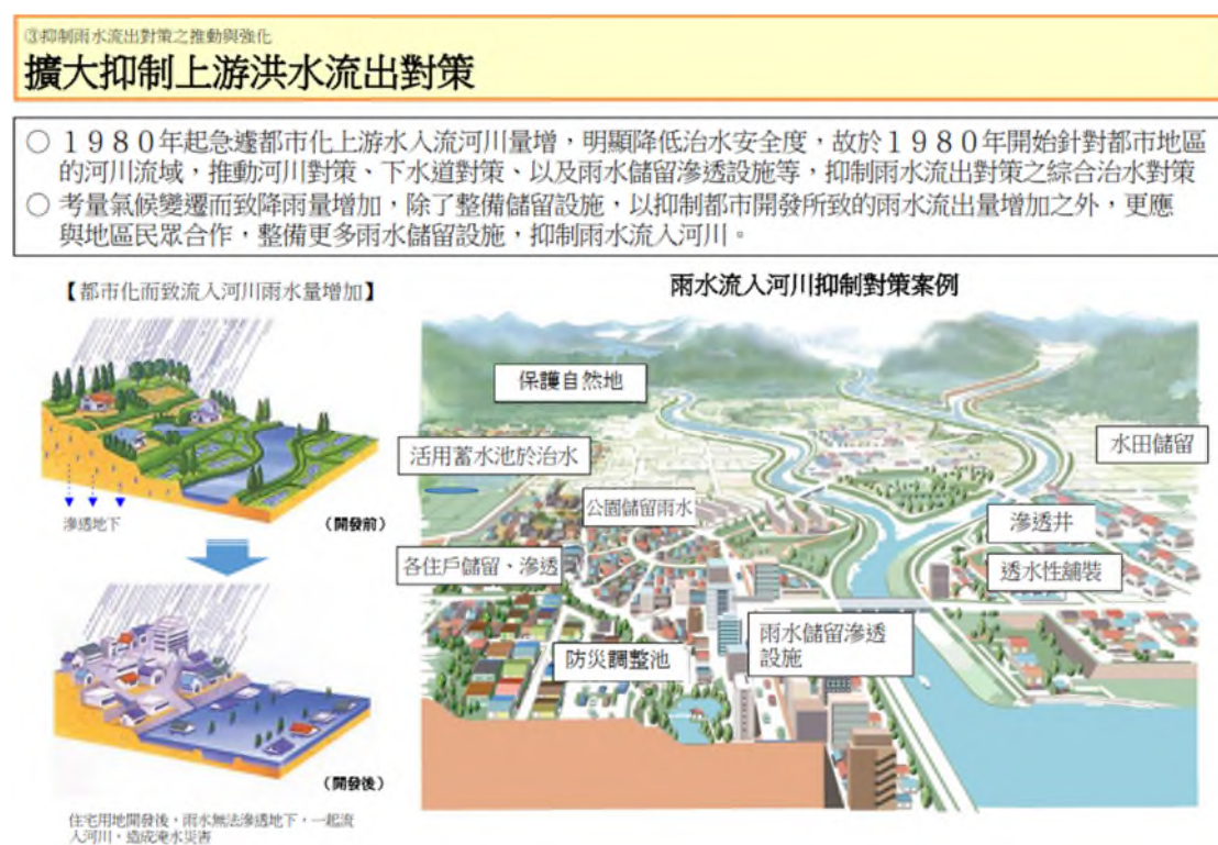
圖 3-21 出流管制對策（國土交通省，2020，氣候變動を踏まえた水災害対策検討小委員会）
