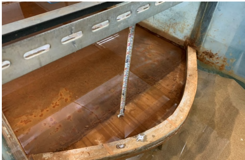
圖 4-31 直尺量測水深之示意圖
