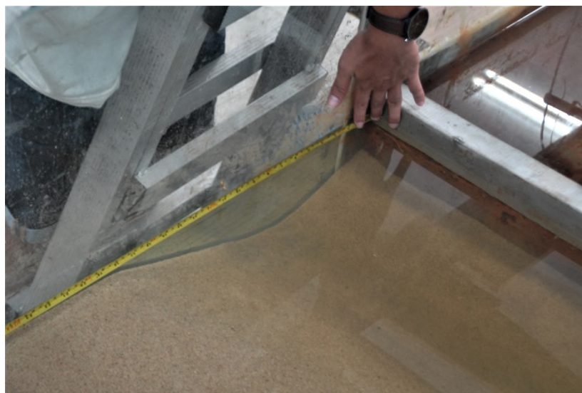
圖 4-39 直尺量測冲刷坑之示意圖
