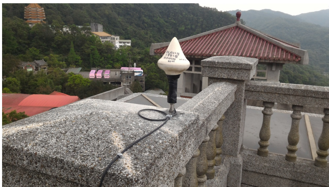
圖 1-4 GPS 連續監測站（單頻 HF02 之天線部件）
