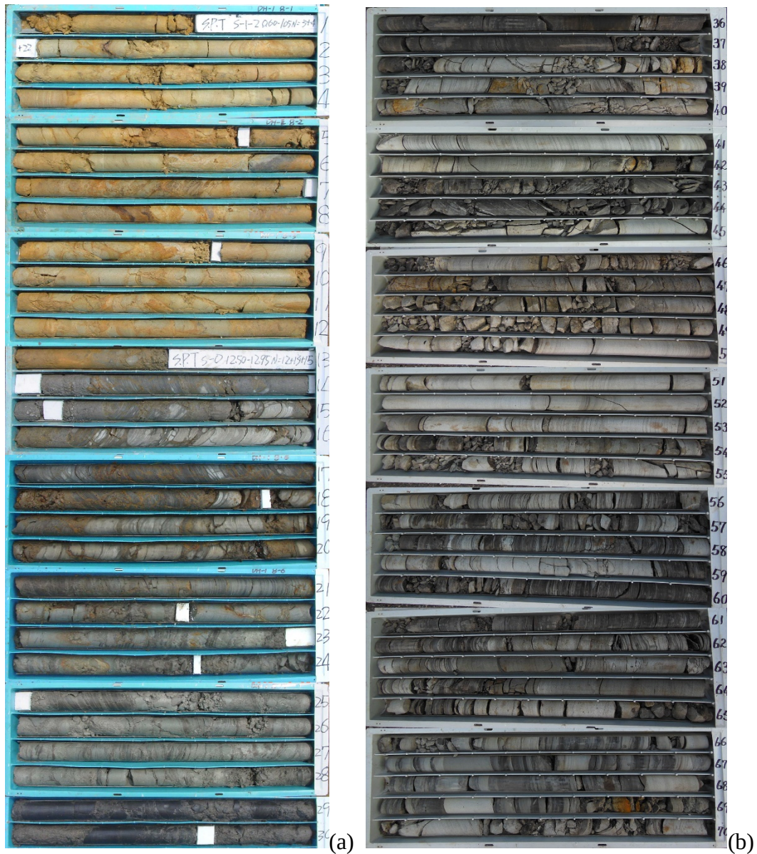
圖 2-4 華梵大學 DH-1(a)與 W-3(b) 岩芯中 A 斷層深度
