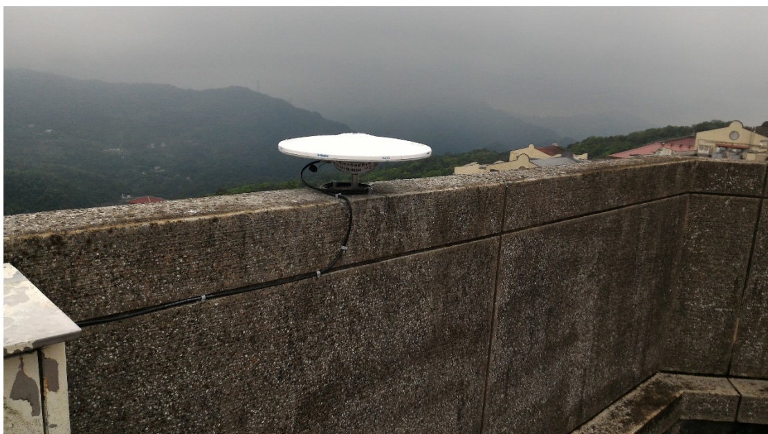
圖 1-5 GPS 連續監測站（雙頻 HFAN 之天線部件）
