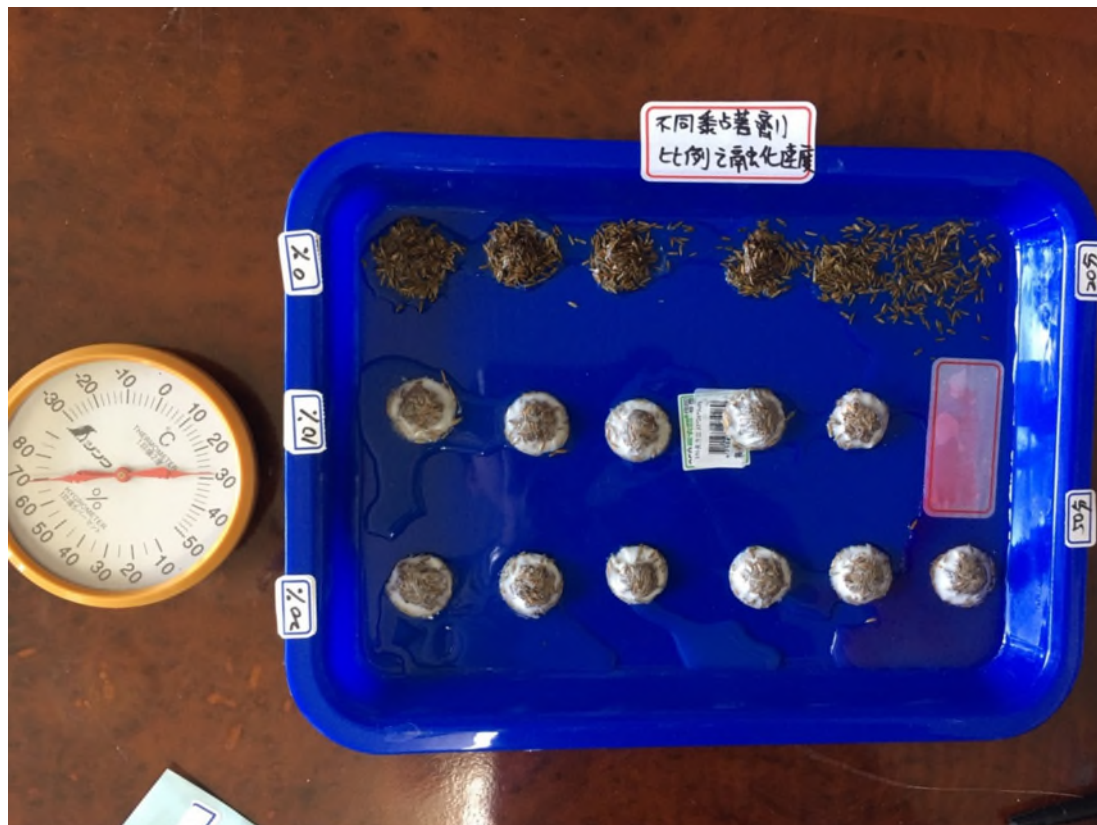
圖 5-3 不同黏著劑比例之融化速度試驗結果
