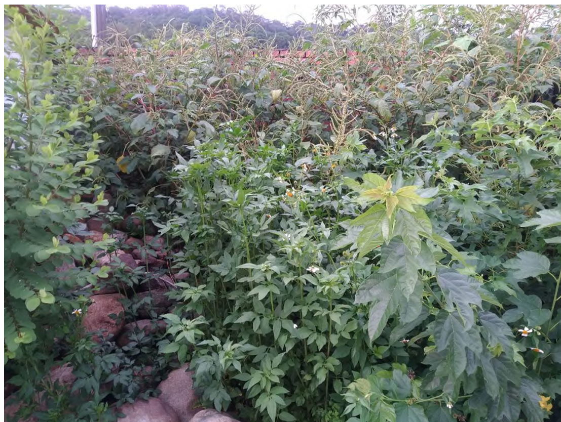
圖 5-21 天然土坡噴植試驗結果(五個月)
