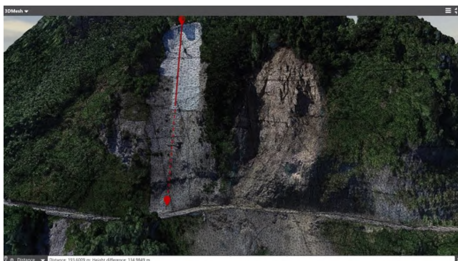
圖 2-10 崩塌邊坡三維空間量測與地形網格特性
