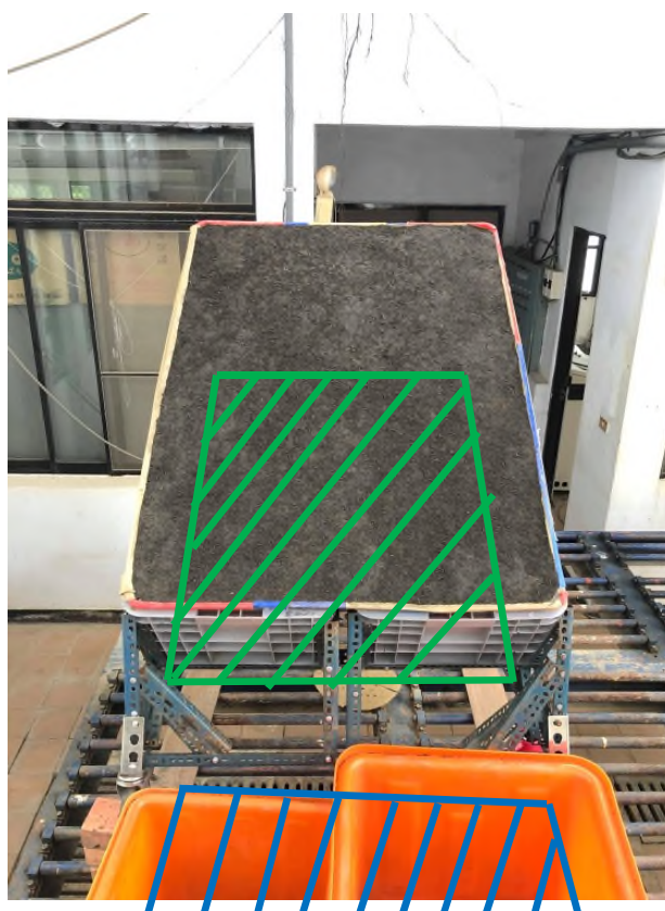
圖 4-1 殘留於坡面(綠色範圍)、滾落至坡下(藍色範圍)及滾落坡旁(其他範圍)示意圖
