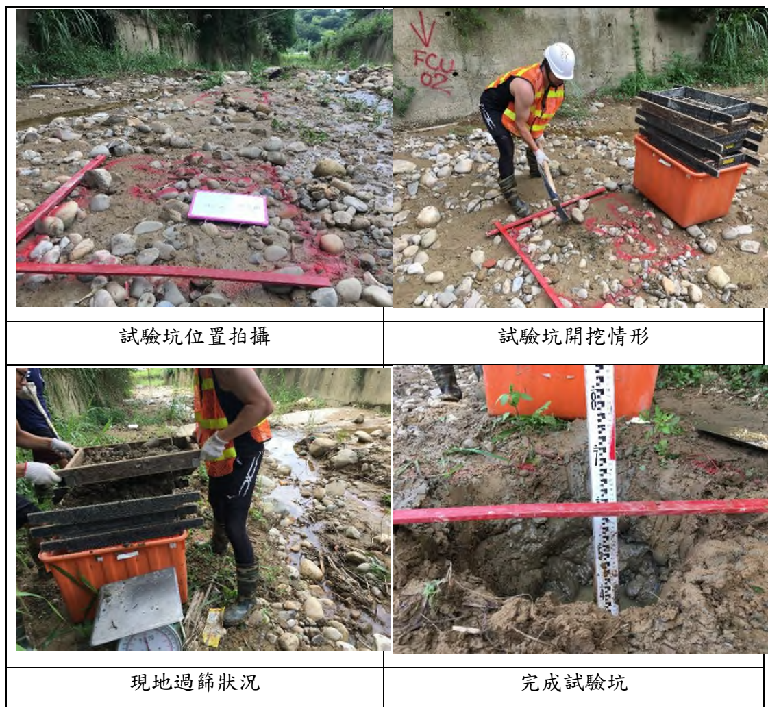
圖二 粒徑現地調查工作狀況
