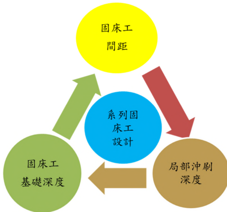
圖 1-3 系列固床工下游溪床局部沖刷深度與其合理間距、基礎深度之關聯性
