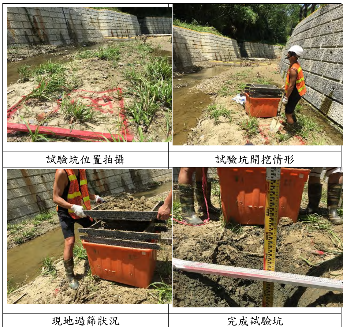
圖二 粒徑現地調查工作狀況
