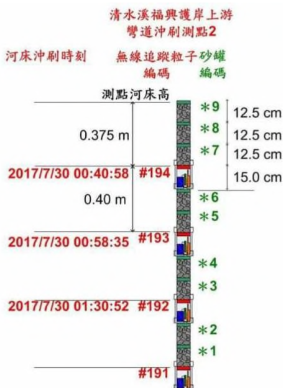
圖 2-8 無線追蹤粒子及配重砂罐組成串磚(清水溪福興護岸河段)
