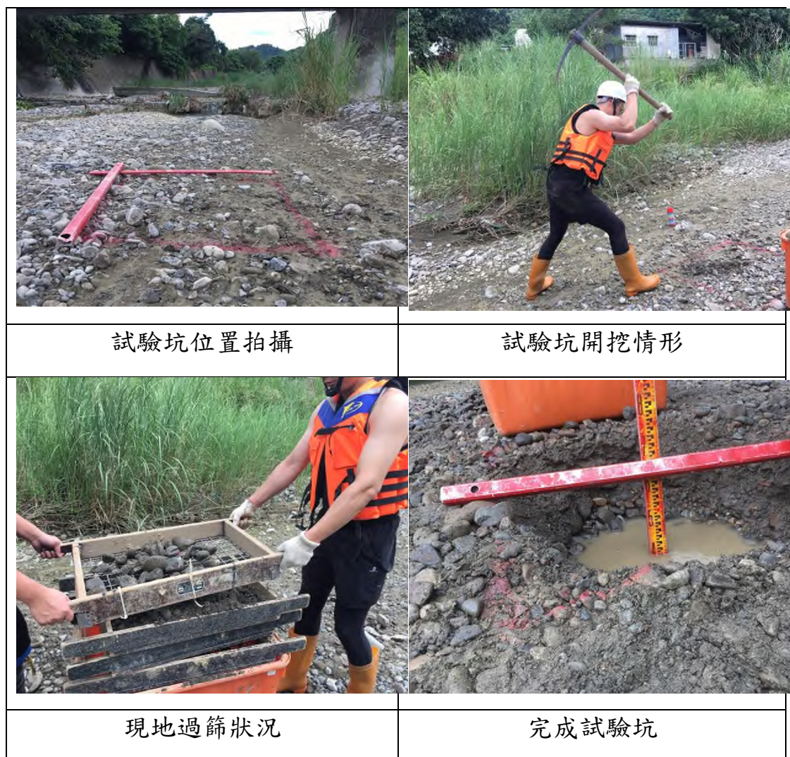
圖二 粒徑現地調查工作狀況
