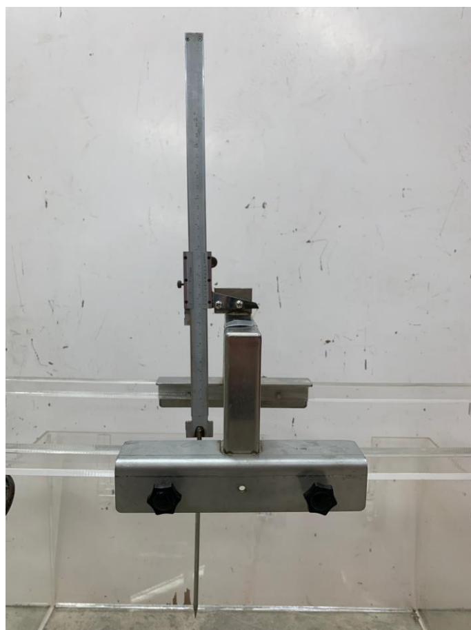
圖 3-6 探針式水位量測裝置
