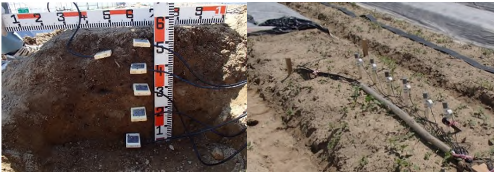
圖 2-1 利用 TDR 與水分張力計進行土壤水分調查示意圖
