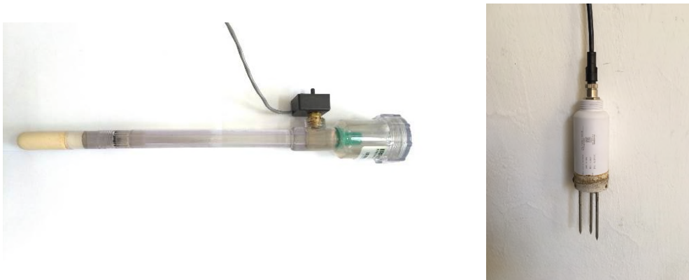
圖 3-2 土壤水分張力計(左)與高感度精密 TDR 水分感測器(右)
