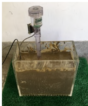
圖 5-3 土壤水分特性曲線之室內試驗配置圖
