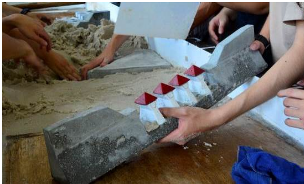
圖 4-34 第3組學生之混凝土縮尺模型及送進動床水槽中測試之過程
