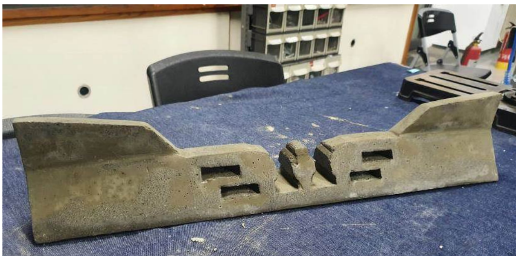
圖 4-17 開發完成之東西坑溪五期工程 1:100 縮尺混凝土模型
