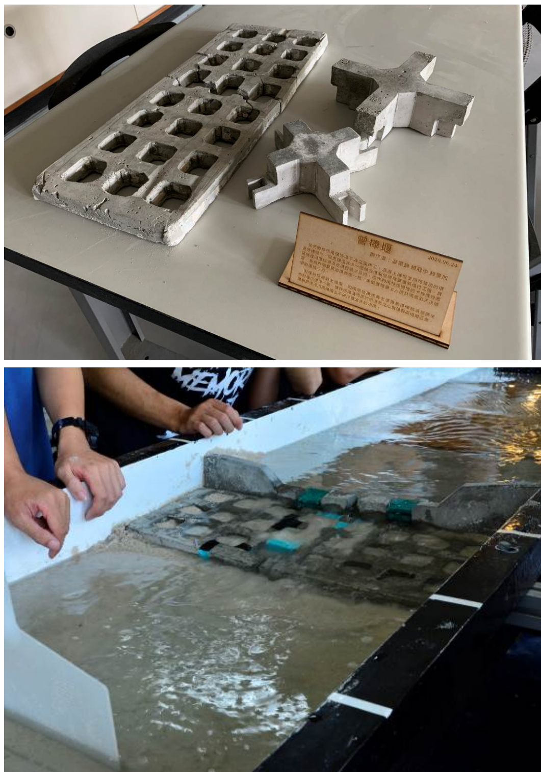
圖 4-31 第 1 組學生之混凝土縮尺模型及送進動床水槽中測試之過程
