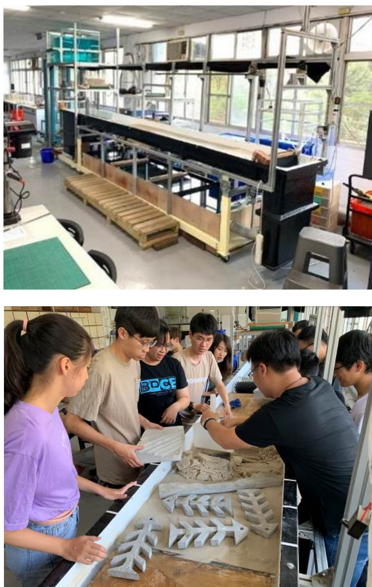
圖 4-19 教學動床試驗水槽
