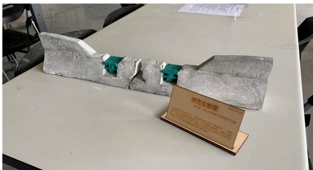
圖 4-21 透過型防砂壩 1:100 之縮尺模型展示
