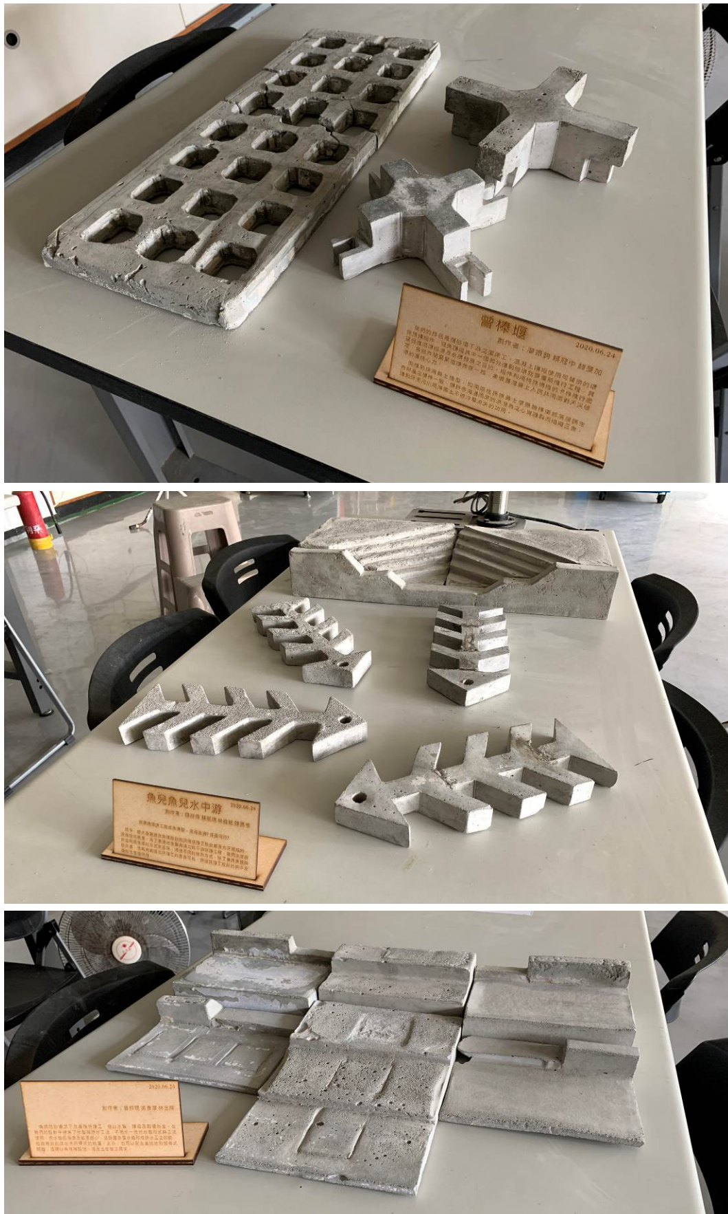
圖 4-22 下游保護工 1:100 之縮尺模型展示
