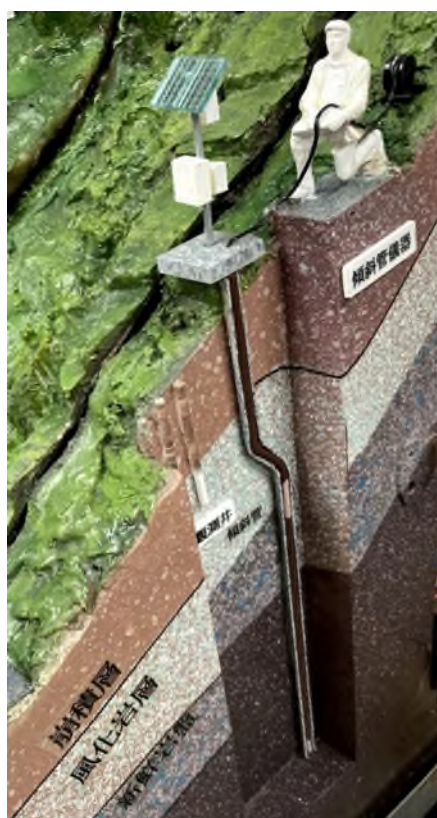
圖 3-25 地中傾斜儀照片(攝於 109/08/14)
