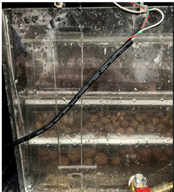
附圖 2-2 教具坡面內之地層模擬套組
