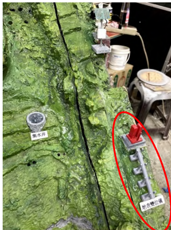
附圖 3-5 地表變位儀模型安裝位置
