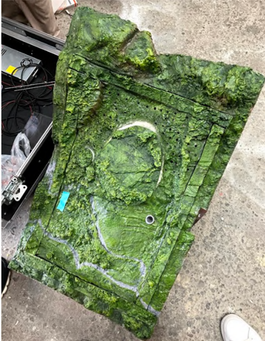
圖 3-3 透過 3D 列印建置之地滑坡面(攝於109/07/07)
