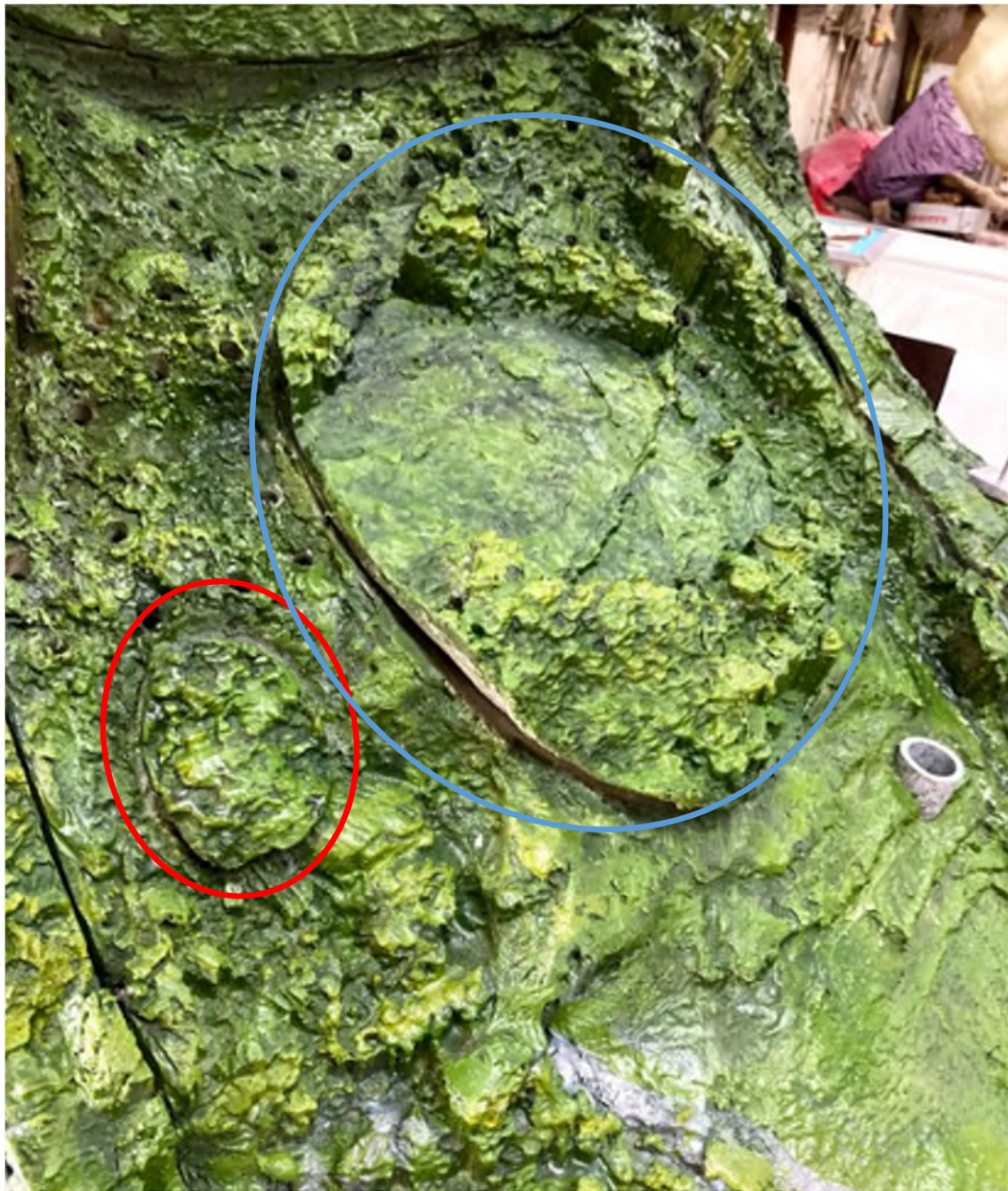
圖 3-9 淺層崩塌(紅框)與地滑(藍框)塊體 (攝於 109/07/07)
