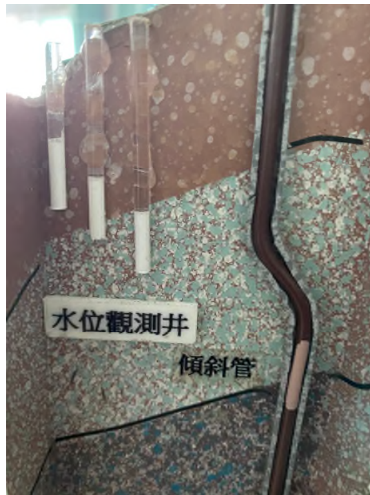
圖 3-23 地下水位觀測井照片(攝於 109/08/14)
