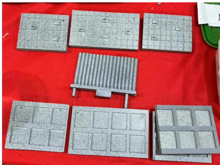
圖 2-10 108 年度教具-工法模擬套組(由上至下分別為地錨、排樁、與 格梁護坡)
