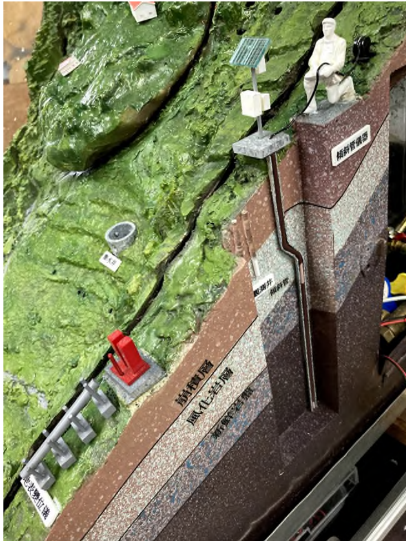
圖 3-5 於教具坡體建置監測設備模組(攝於 109/08/31)
