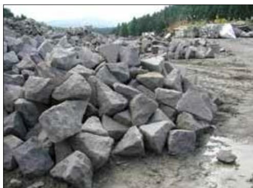
四角石材與雜切割石加工狀況 需一塊一塊加工，相當費時
