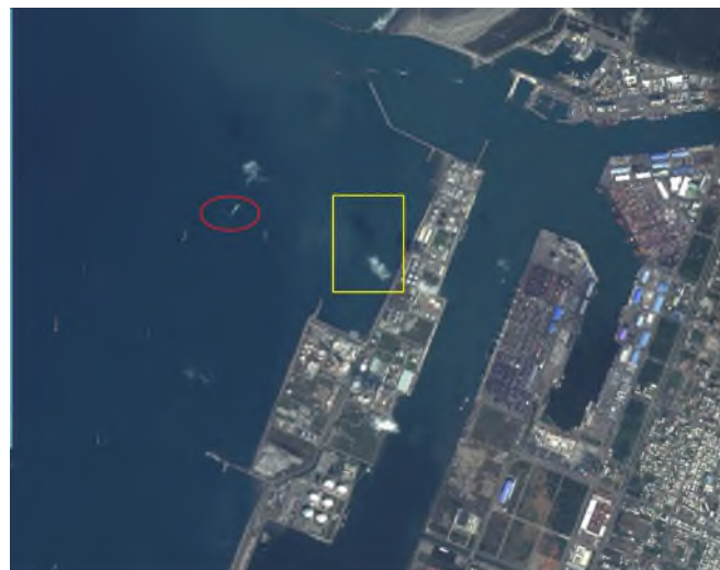
圖 17 此例為港灣地區常見特徵之範例；漁港灣地區為開放式水域，常見到筆直的人工堤防、行徑中的船隻與船痕(紅框)、近岸水流之紋
