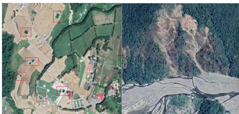
圖 21 此例為判釋裸田地與崩塌地之範例；一般乾燥的裸田地與乾燥的崩塌地色調相近，但田地形狀通常接近矩形、隱約可看見規則排列之紋理於中(犁田的痕跡)、附近常有蓄水(左圖紅框)池及住家，而崩塌地常發生於河道上方，且形狀常呈現狹長狀、湯匙狀等不規則狀，且通常緊鄰林地(質地成綠色顆粒不均狀)
