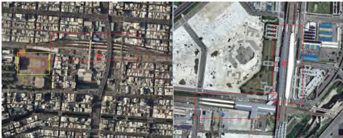
圖 19 此例為車站判釋之範例；車站因有月台及會車之功能，故車站之軌道常有軌道變多(如左圖紅框為高雄火車站)或是月台遮雨(右圖紅框為台中高鐵站，兩圖紅框中白/灰色之色塊及為月台範圍)之現象；此外，室外田徑場通常呈現圓弧狀，且中間有長矩形之色塊(左圖黃框)
