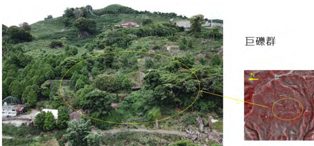
圖 53 巨礫於 HOST MAP 之表現上為一顆微微突起、似青春痘般的樣貌，如圖中所示，巨礫不易被風化與侵蝕，故突出於邊坡表面形成獨立的突起地貌，對照至左圖(UAV 拍攝)即可印證當地有許多巨礫群
