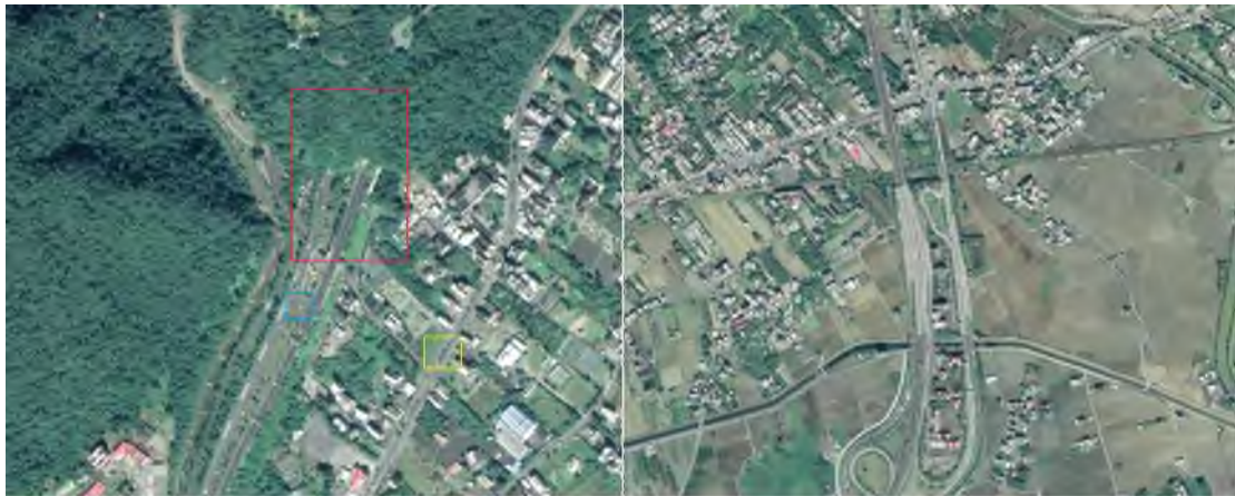
圖 18 此例為隧道判釋之範例；一般道路為連續不中斷型之線條(如右圖)，而隧道會突然出現在某個邊坡上(如左圖紅框)，此外，道路上常出現汽車及行道樹，兩者差異在於行道樹位於道路兩側且偶因高度產生陰影(左圖黃框)，而汽車常位於道路中間且無陰影(左圖藍框)
