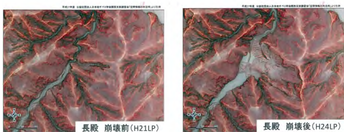
圖 33 崩塌前後地貌比對組一(資料來源：2018 年水土保持局大規模崩塌防減災技術交流國際研討會簡報內容)
