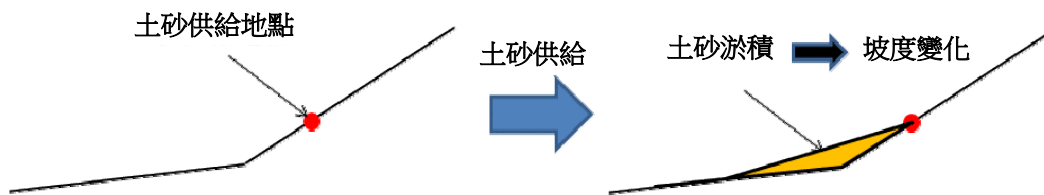
圖 2.4 土砂淤積引致土砂供給地點坡度變化示意圖
