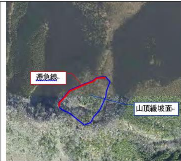
航空照片 運用立體視的方法，就能判釋遷急線範圍內與下方陡坡隔開的山稜上方平坦面。
