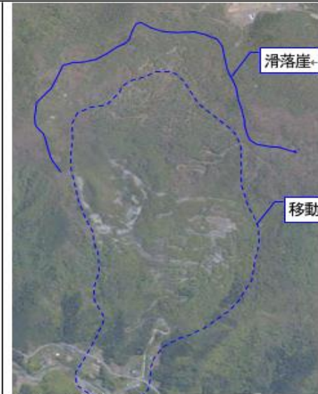
航空照片 可用立體視的方式，一起判釋頭部的急崖（滑落崖）與下方緩坡面（移動體）。
