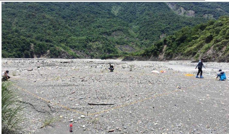
圖 2-2.3 河床表層粒徑現場調查樣區設置圖
