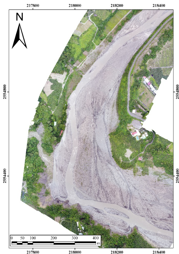
圖 3-3.9 無人飛機航拍正射影像產製成果(航高 200 公尺)
