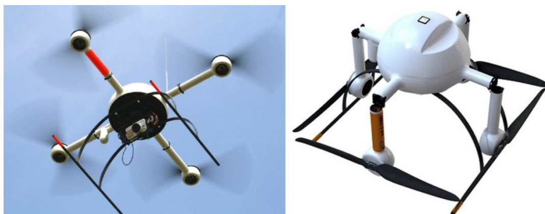
圖 3-1.2 多旋翼型無人載具 Microdrones MD4-1000 外觀
