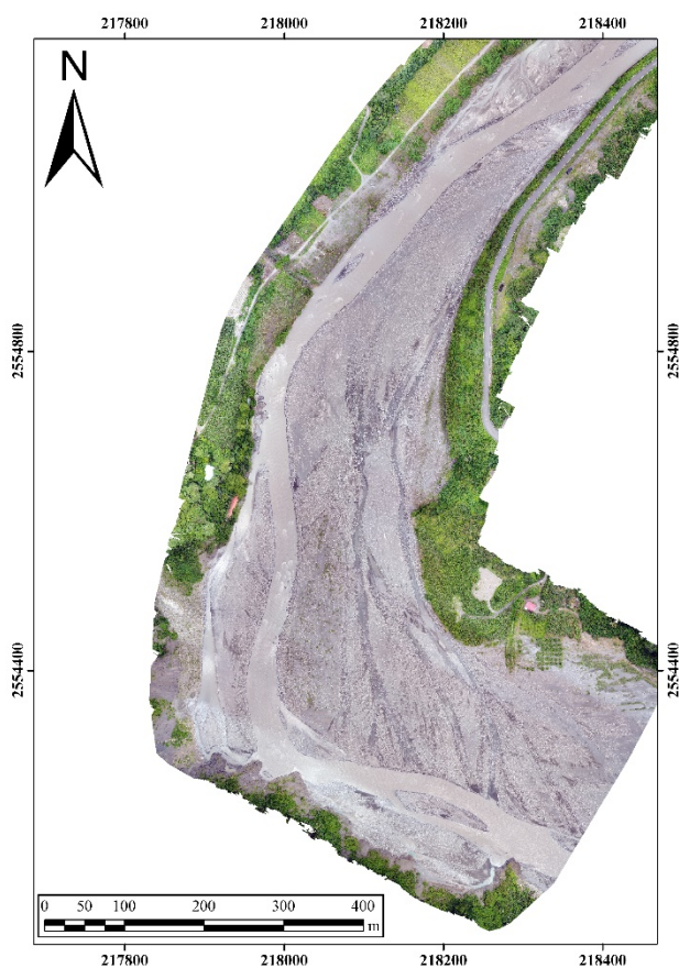
圖 3-3.8 無人飛機航拍正射影像產製成果(航高 100 公尺)
