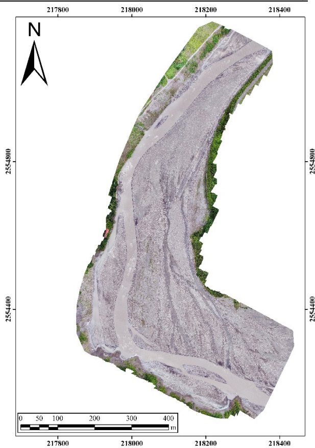
圖 3-3.7 無人飛機航拍正射影像產製成果(航高 50 公尺)
