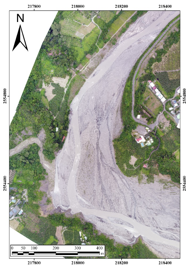
圖 3-3.10 無人飛機航拍正射影像產製成果(航高 400 公尺)
