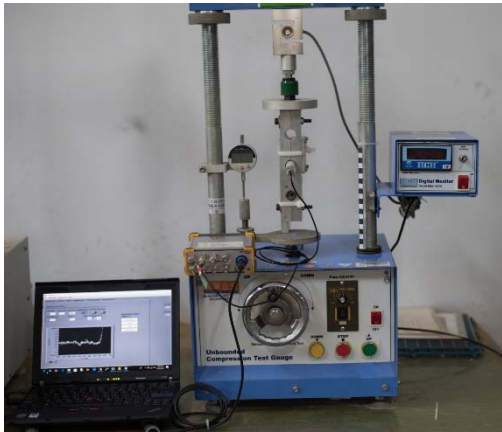
圖 4.19 未改良與改良後纜線灌漿試體進行簡易直接剪動試驗
