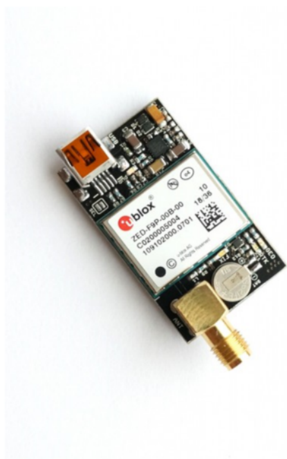
圖 4.9 新式 ublox F9P 雙頻 GNSS 晶片模組 3
