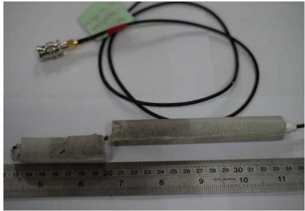
圖 4.19 未改良與改良後纜線灌漿試體進行簡易直接剪動試驗
