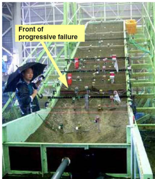
圖 3.4 日本坡地簡易傾度量測系統之物理模型試驗 (Uchimura et al. 2010)
