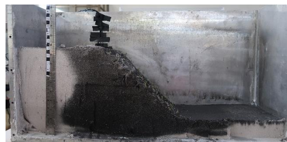
(b) 移除試驗箱壁之模型側視圖
