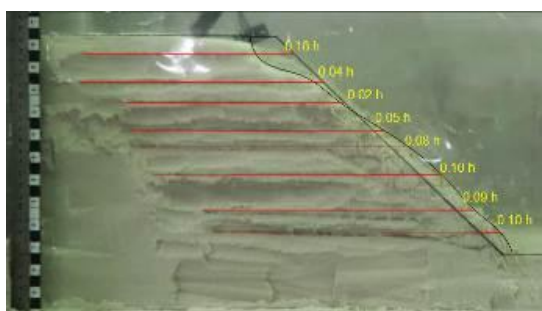
試驗後模型試體側向滑移圖
