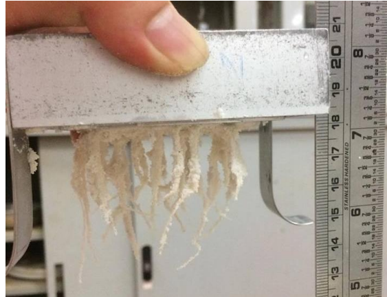
圖 3-9 根沿破壞面拉出並未剪斷
