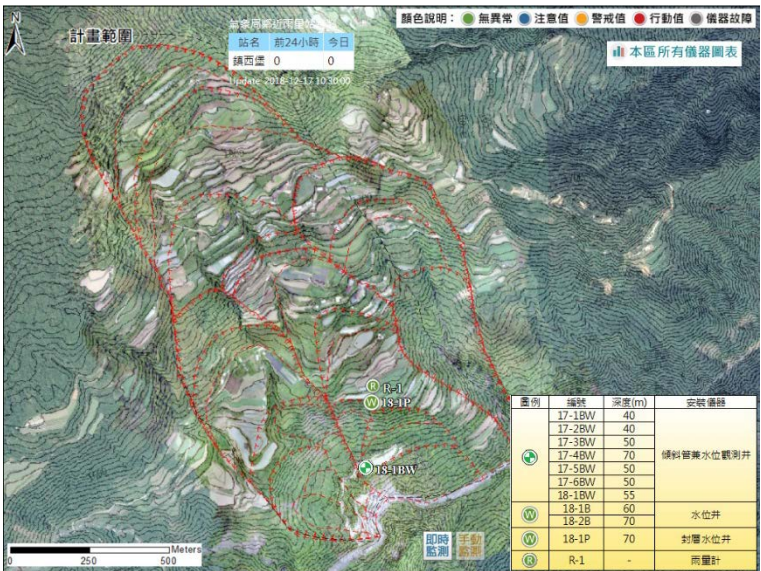
圖2-4 鎮西堡崩塌地監測系統圖
