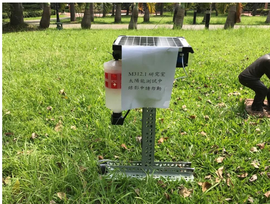
圖 3-3-12 太陽能供電站與誘蟲計數器裝置-戶外測試
