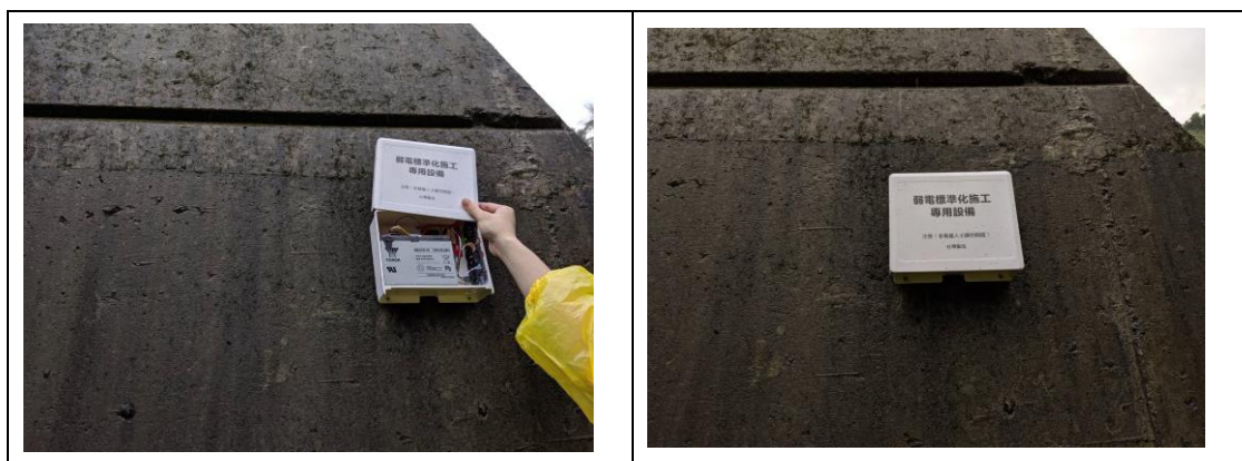
圖 2-22 本計畫於烏來忠治 5 號壩所設置之智慧感測元件
