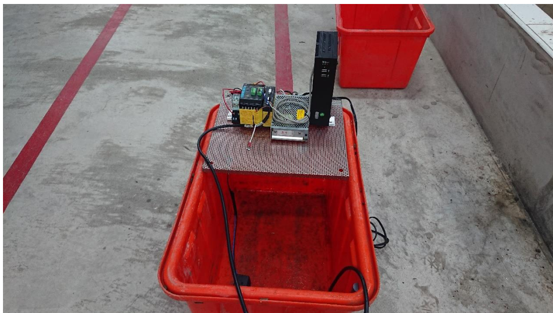
圖 2-10 無線傳輸及自動控制模組
