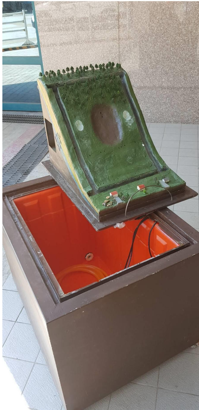
圖 3-1.1 模型主坡體(上)與模型基座(下) (攝於 108/09/25)
