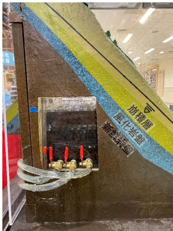
附圖 2-3 地層水位高度的觀測窗
