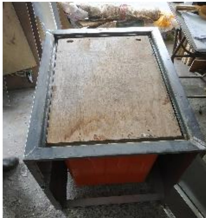
圖 3-1.9 教具主坡體收納進入蓄水槽裝置內(攝於 108/07/03)
