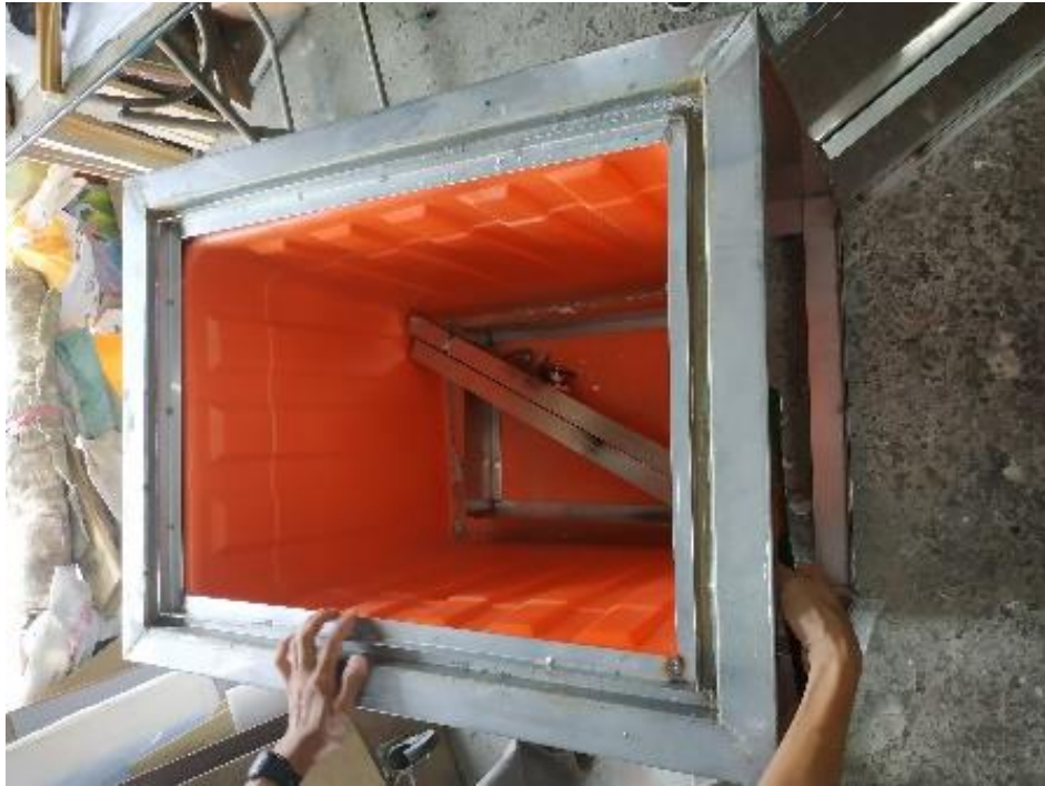
圖 3-1.10 灑水槽收納進入蓄水槽裝置內攝於(108/09/20)
