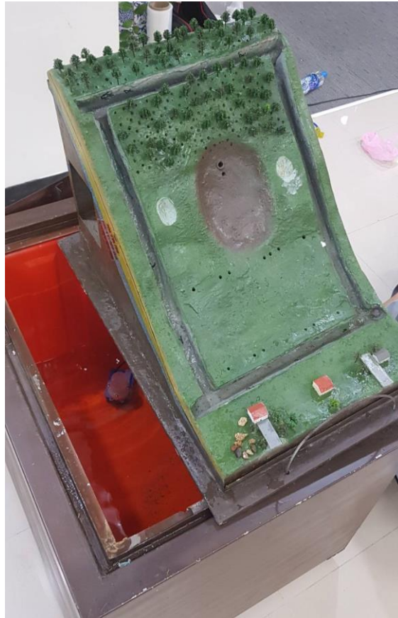
附圖 1-7 主坡體安裝於基座上方
