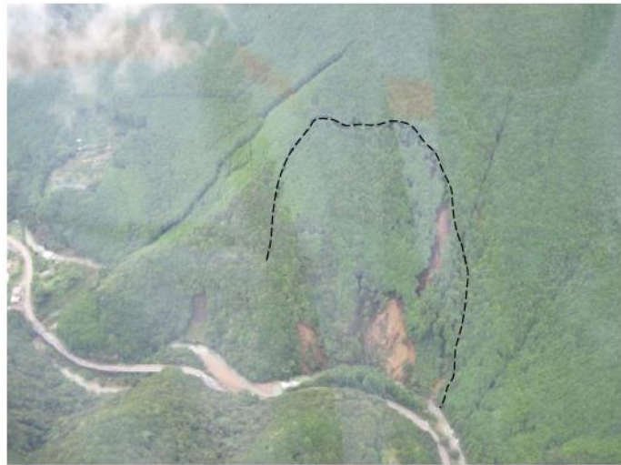
写真-5.2.33 斜め空中写真（水野撮影）に地表踏査で確認した亀裂等変状範囲を加筆 全体ブロック 長さ約 250m、幅約 170m
