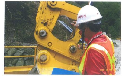
說明：檢查插銷穩固、油管正常。
