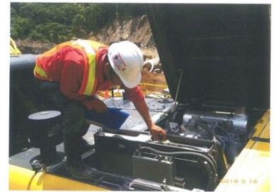
說明：確認水箱、電瓶功能正常。
