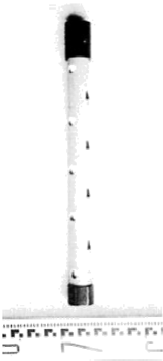
A：Casagrande 滲壓計尖端 部位
