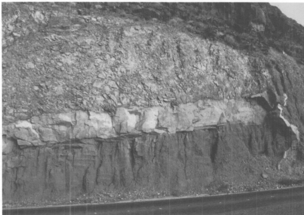
圖 5.24：層狀材質容易出現差異性沖蝕
