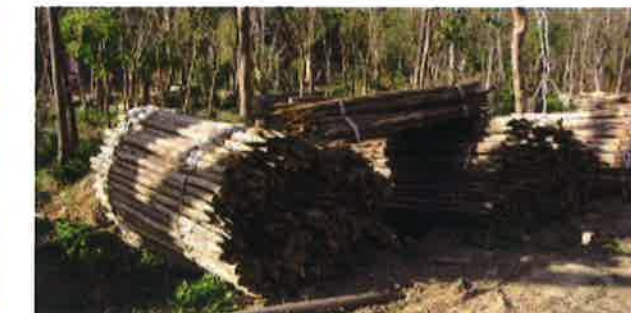
支架木樁材料(經裁剪與防腐處理)
