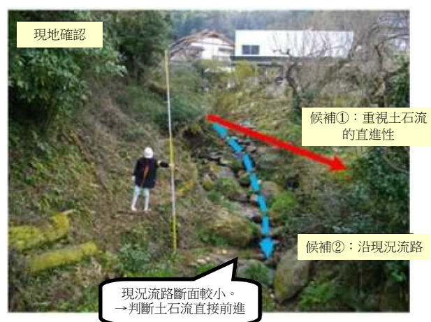
圖Ⅲ- 2.24 土石流流動方向的設定例
