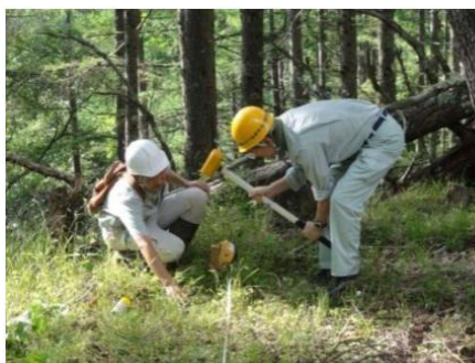
圖 2.2.2 移動樁的設置
