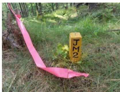
圖 2.2.3 完成設置的移動樁
