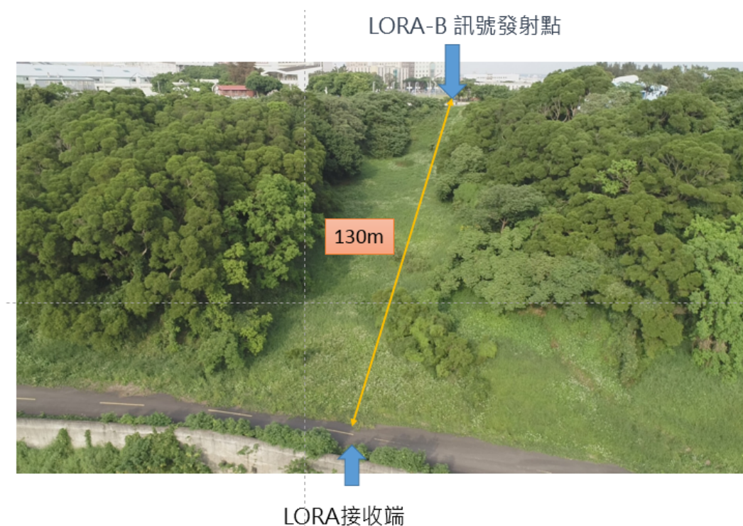
圖 3-1 試驗 A 之配置(107.6.22 攝於明新科技大學後山校地)
