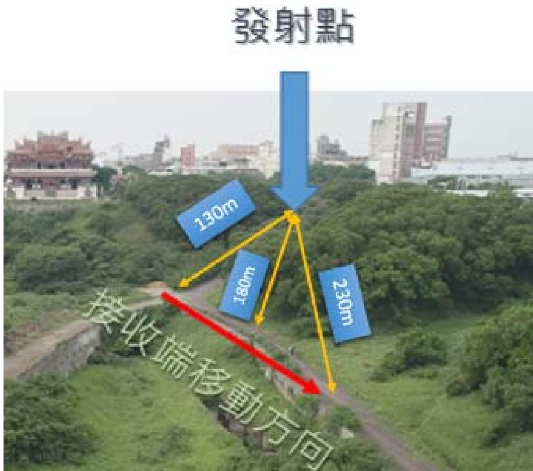
圖 3-4 試驗 B 之配置(107.6.22 攝於明新科技大學後山校地)
