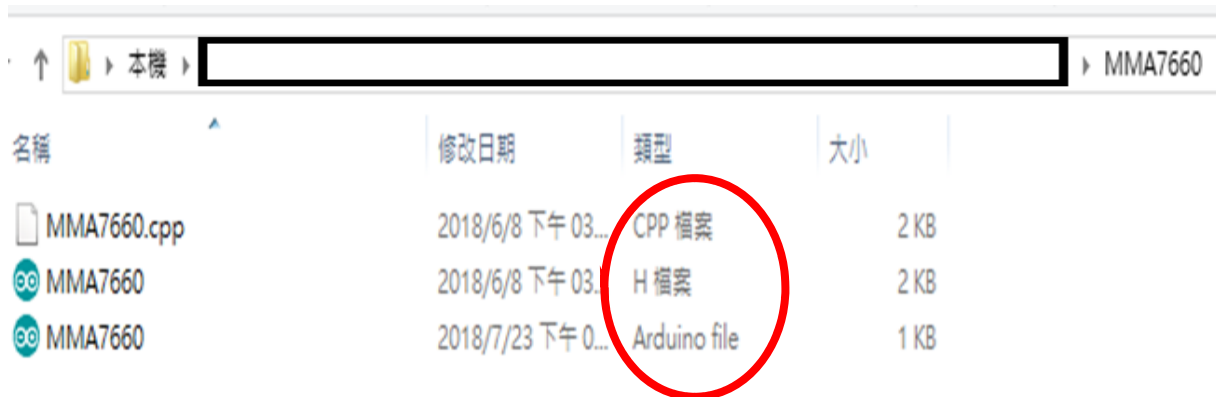
圖2-24 cpp*檔與h*檔放置在Arduino檔旁邊以便顯示程式碼之圖示
