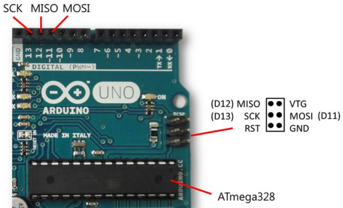
圖2-16 ICSP (In-Circuit Serial Programming) 腳位
