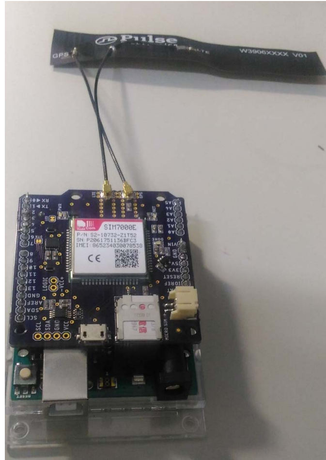
圖3-23 SIM7000E之Arduino擴展板與Arduino板連接圖
