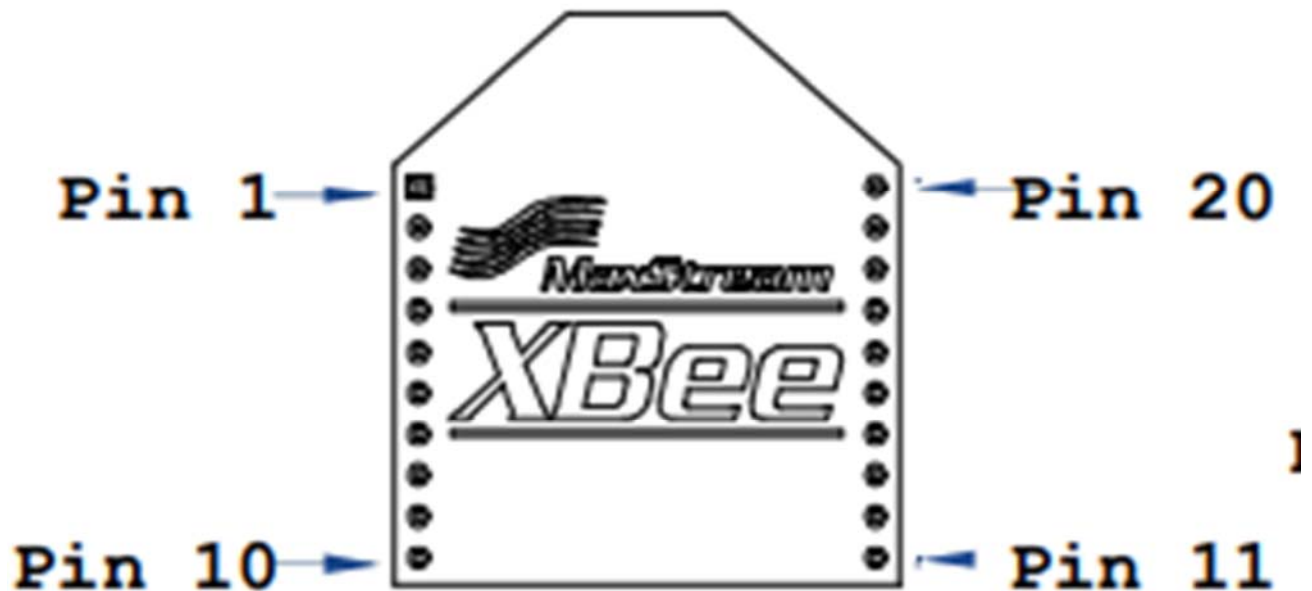
圖 3-31 XBee S2 模組腳位示意圖
