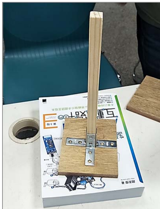
圖 5-25 室內模擬之懸臂梁模型
