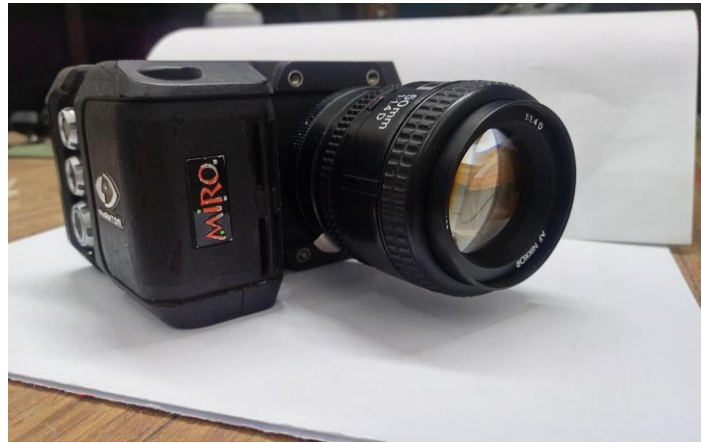
圖 3-5 高速攝影機-Phantom Miro ex4
