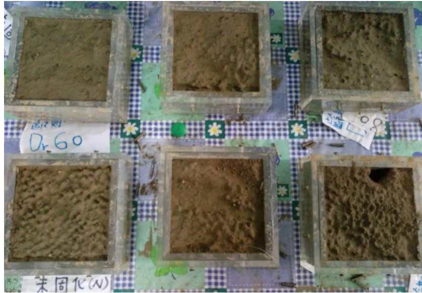
圖 4-5 不同相對密度下試體之沖蝕破壞情形 ( I=41\text{mm/hr} )
