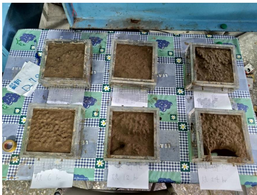
圖 4-3 不同含水量(烘乾時間)試體沖蝕之情形 ( I=66\text{mm/hr} )
