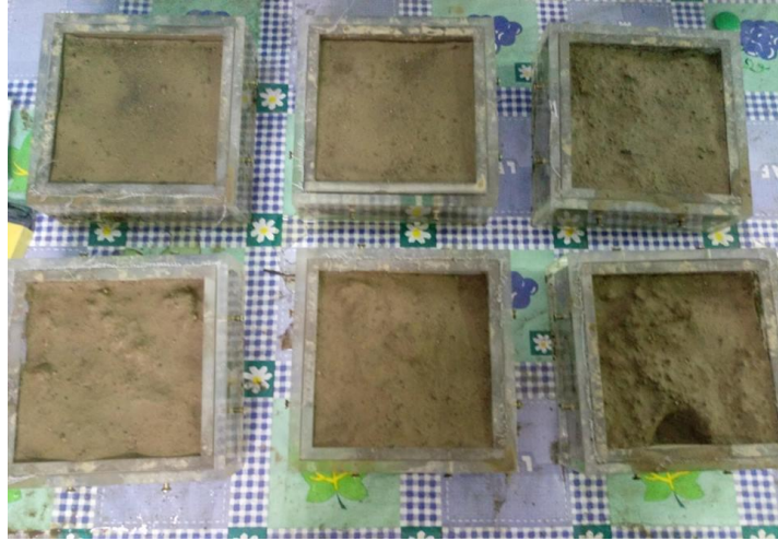
圖 4-1 不同含水量(烘乾時間)下試體沖蝕之情形 ( I=41\text{mm/hr} )
