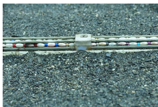
S=0.04 、 D_{50}=1.05\text{mm} 、 Q=8.7 \times 10^{-4}\text{cms}
