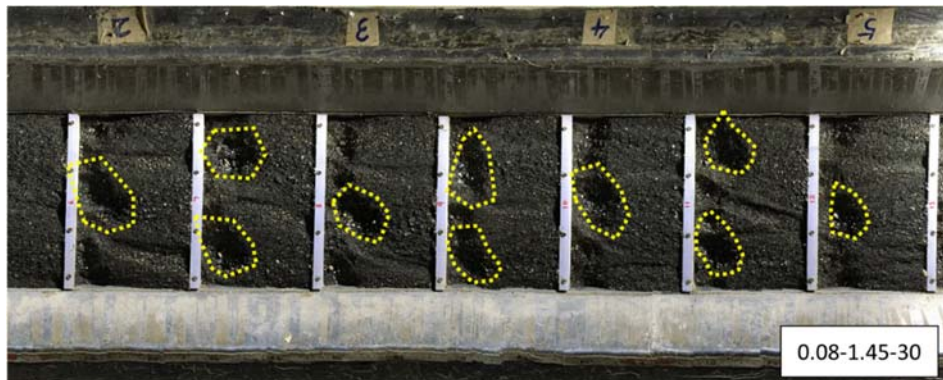
圖 23 透水式 B 型固床工間淘刷坑交錯發展的情形
