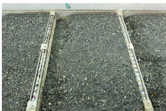
(C). S=0.08 、 D_{50}=1.45\text{mm} 、 Q=4.5 \times 10^{-4}\text{cms}
