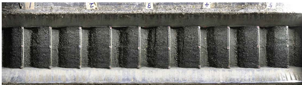
(C). S=0.08 、 D_{50}=0.85\text{mm} 、 Q=8.7 \times 10^{-4}\text{cms} 全景
