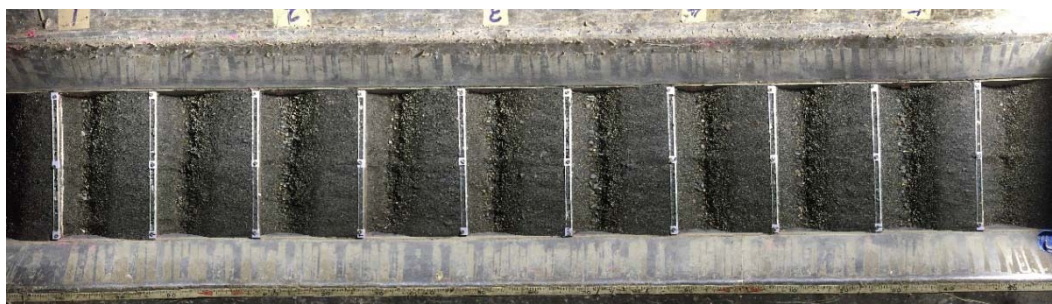
(C). S=0.08 、 D_{50}=0.85\text{mm} 、 Q=8.7 \times 10^{-4}\text{cms} 全景
