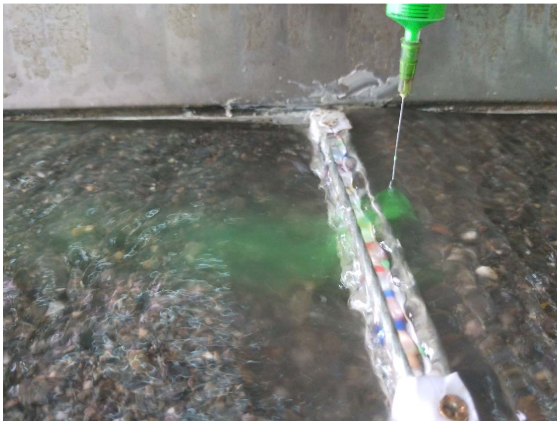
圖 31 水流通過透水式 E 型固床工通透體時所產生的擴散現象
