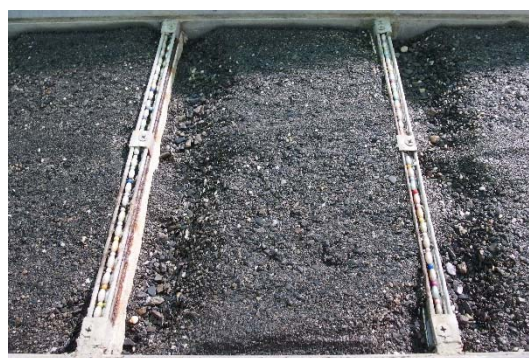
(D). S=0.06 、 D_{50}=1.05\text{mm} 、 Q=4.5 \times 10^{-4}\text{cms}
