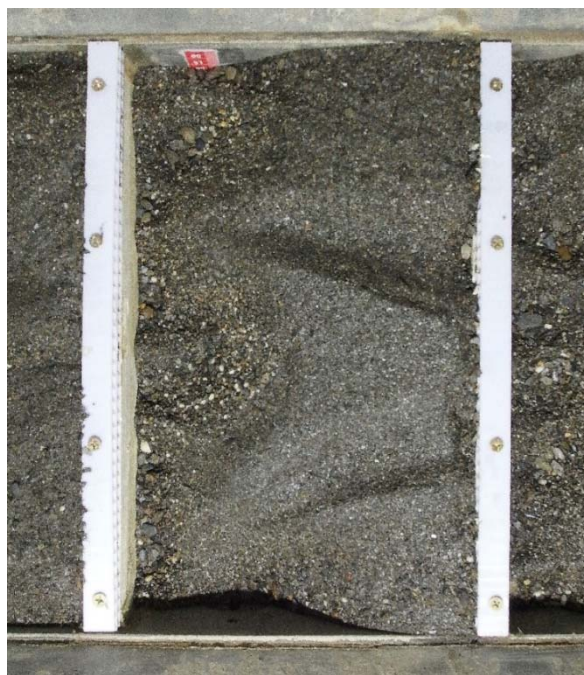
圖 24 透水式 B 型固床工間渠床淘刷之發展
