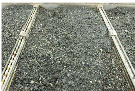
(A). S=0.04 、 D_{50}=1.45\text{mm} 、 Q=8.7 \times 10^{-4}\text{cms}
