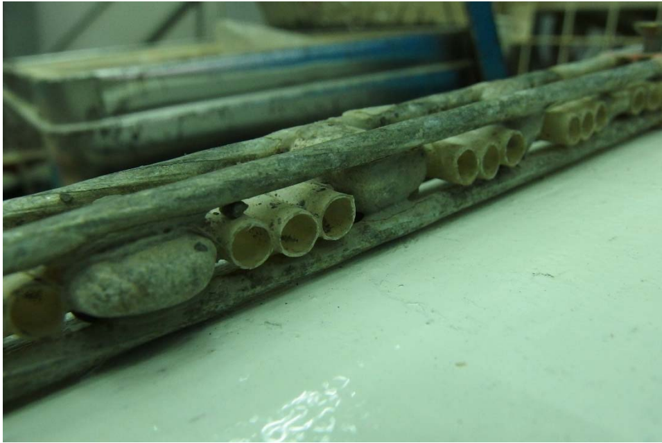
圖 11 透水式 D 型固床工通透結構迎水面之結構近照
