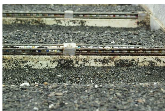
S=0.08 、 D_{50}=1.45\text{mm} 、 Q=8.7 \times 10^{-4}\text{cms}
