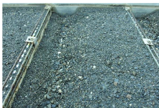
(B). S=0.06 、 D_{50}=1.05\text{mm} 、 Q=6.7 \times 10^{-4}\text{cms}
