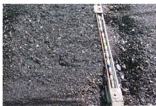
S=0.06 、 D_{50}=1.05\text{mm} 、 Q=4.5 \times 10^{-4}\text{cms}
