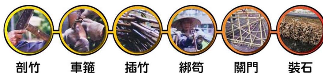
圖 4-17：籠仔筴製作流程圖 (資料來源:烏塗社區搶水節，計畫再整理)
