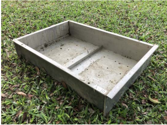
圖 2-2 自製舊式不鏽鋼試樣盒
