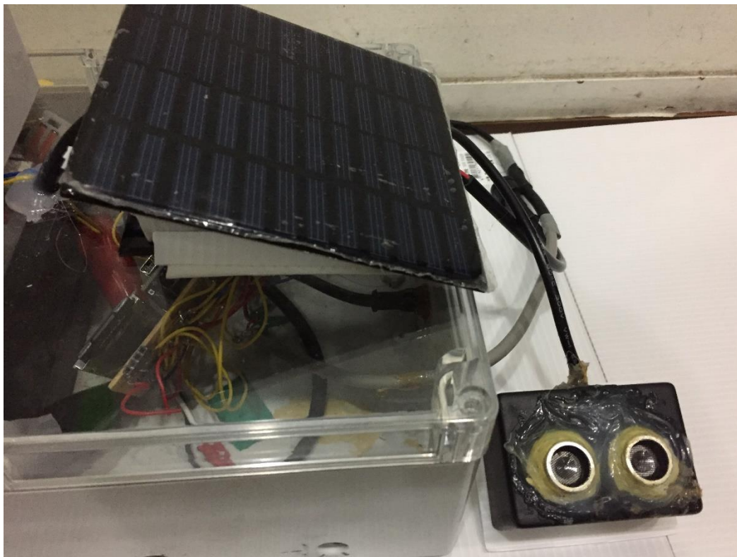
圖 4-15 太陽能板和超音波感測器
