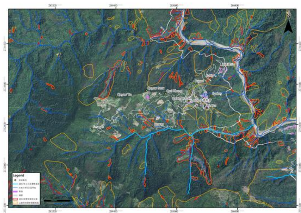
圖 4-15 高義部落附近土石流潛勢溪流、水系分析、 2013 年歷史坡地災害及山崩與地滑地質敏感區地圖
