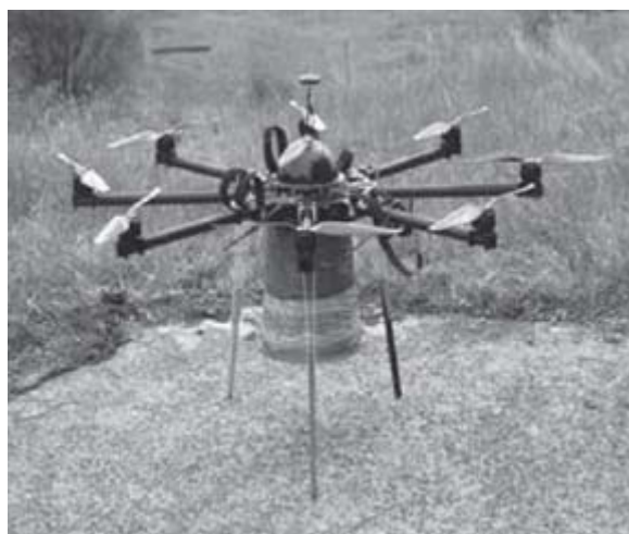
圖 2-12 UAV 搭載 Gamma 光譜儀
