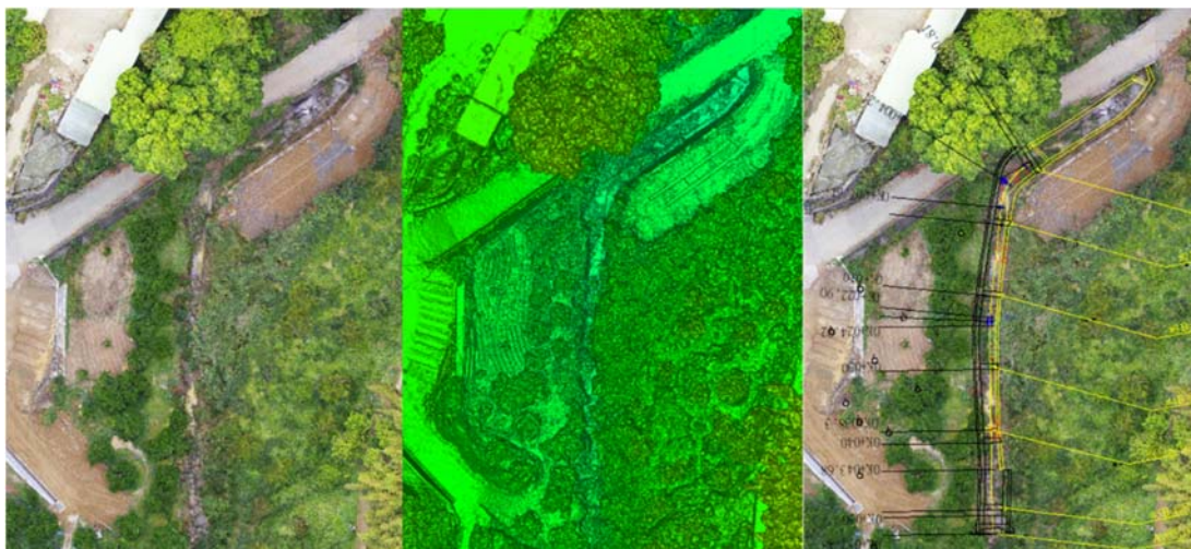
圖 2-26 正射影像(左)、DSM(中)、圖說套疊(右) 新店大東勢溪上游支流整治工程拍攝成果-施工前
