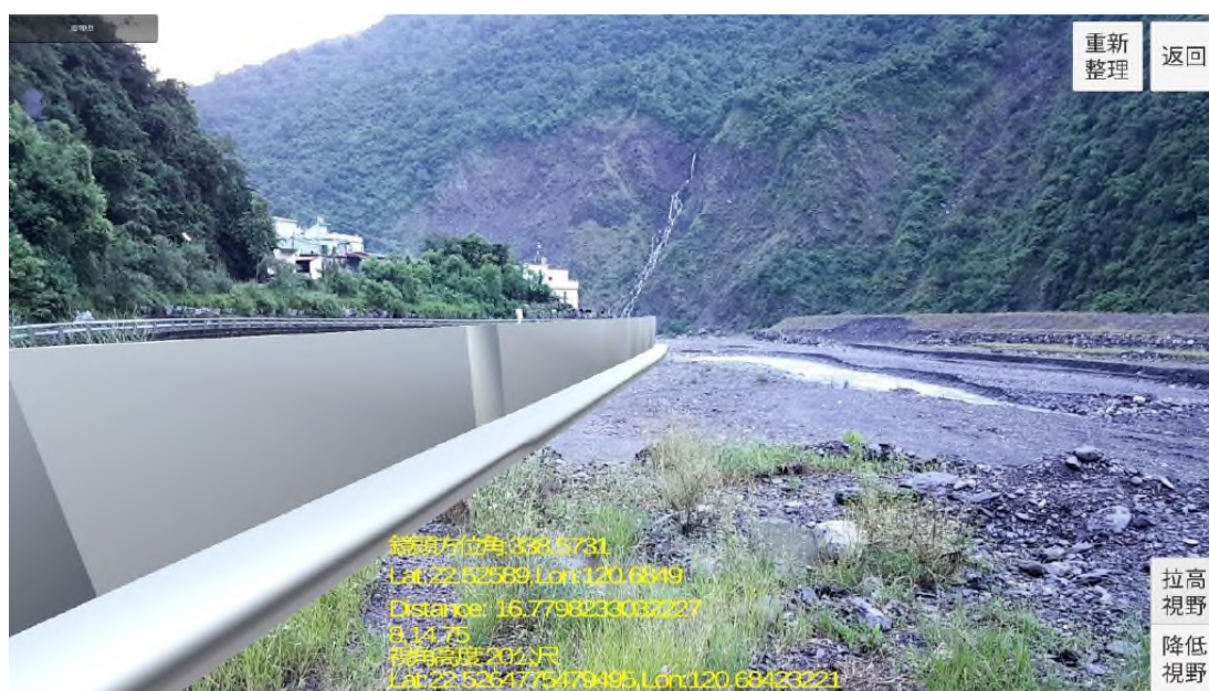
圖 4- 32 虛擬放樣現況與現場實物比對(放大手機螢幕畫面)
