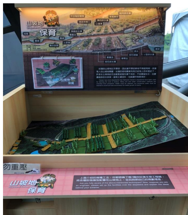
圖 3-1.5 山坡地保育工法配置-簡易工法模型
