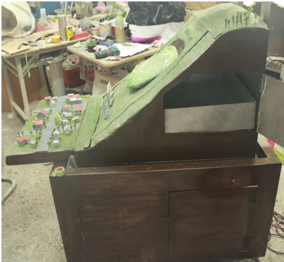
附圖 2-3 地層內的方型蓄水槽
