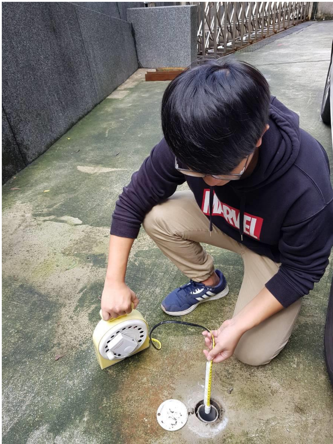
簡易地下水量測儀器，透過感應的方式可以量測到地下水水位實際位置
