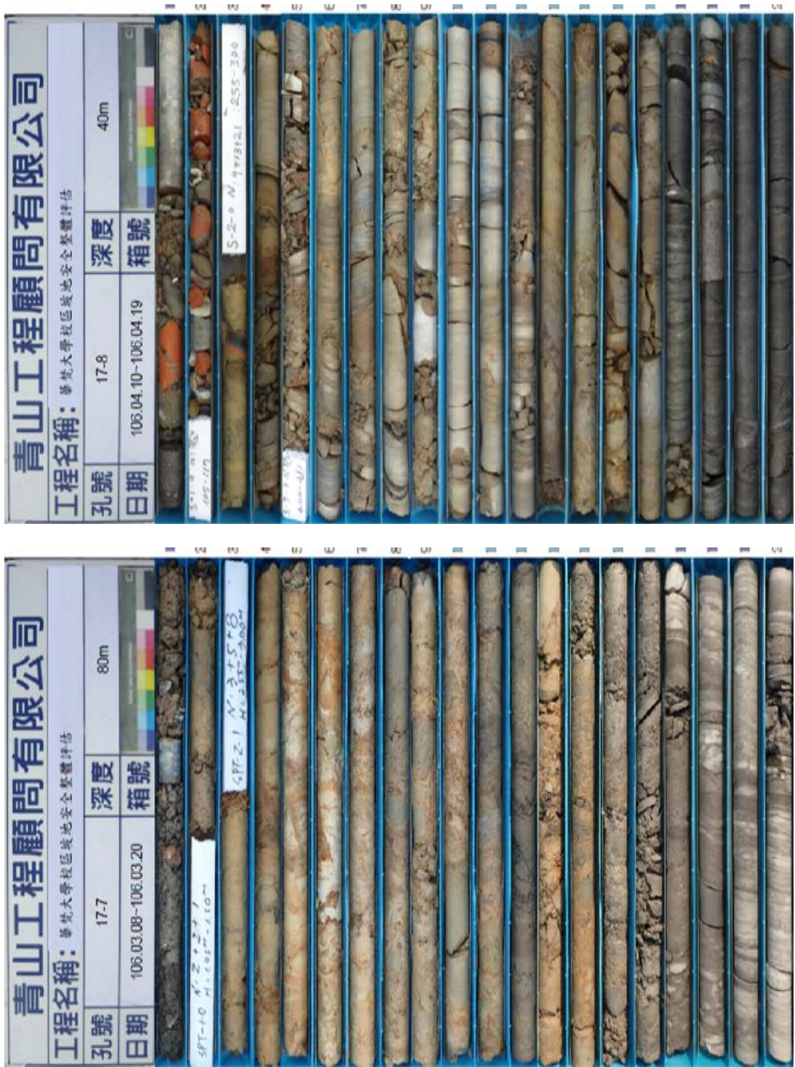
圖 2-5 岩芯 17-7 與 17-8 所呈現地層材料情形
