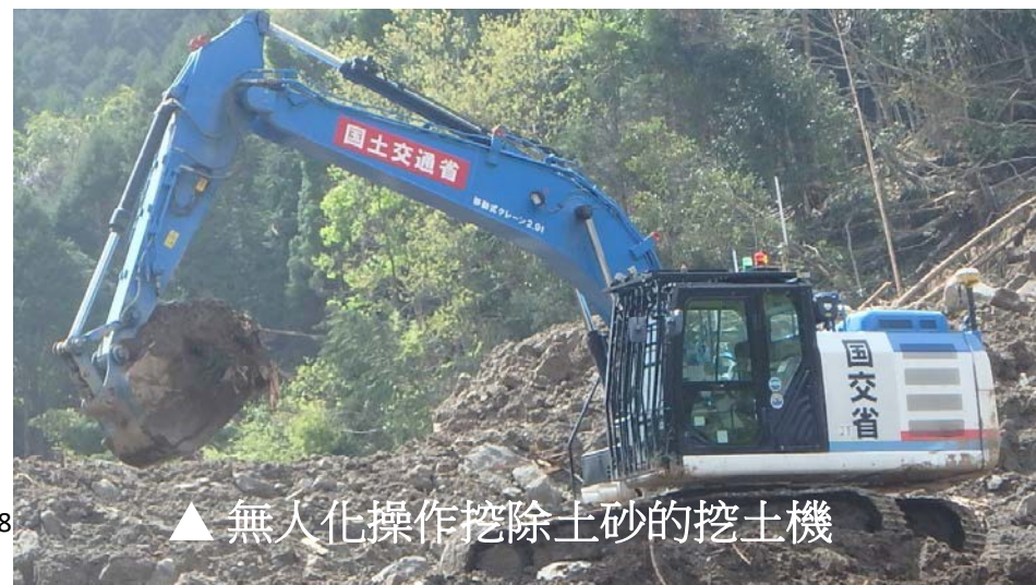
▲遠距操作式挖土機的操作狀況
