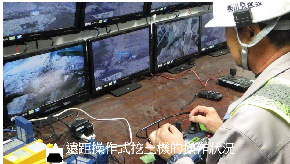
▲快速架設無人化施工所需的移動式遠距操作式挖土機
