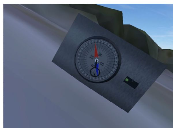
地質羅盤儀量測坡面傾角
